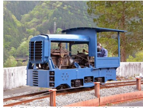
▲デモ運転中の米川鉄工所製 3.5トンガソリン機関車 名称:銀河3号
